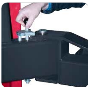
Arrêt rotation bras à secteurs dentés.
