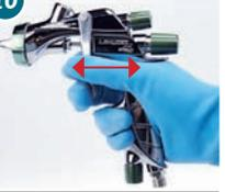
Vérifiez si la gâchette et l'aiguille fonctionnent normalement
