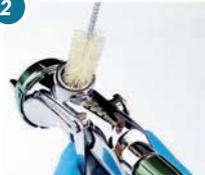
Nettoyez le raccord produit à l'aide d'une soufflette et d'un goupillon
