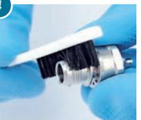
Nettoyez le filetage et les passages d'air de la buse
