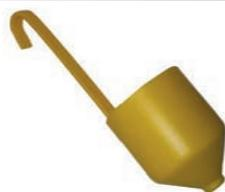
Permet de mesurer la viscosité des peintures liquides.
